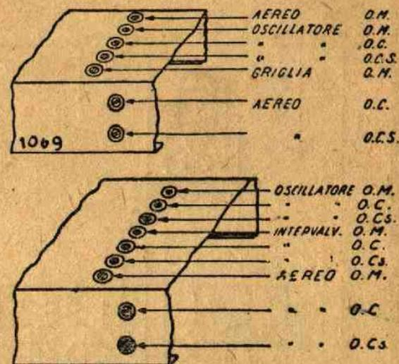
La disposizione dei compensatori nei telai "Phonola 559,, e derivati. In alto, per i modelli 561/A, 562/A, 561/B; in basso per i modelli 559; 559/A; 559/F; 562.
